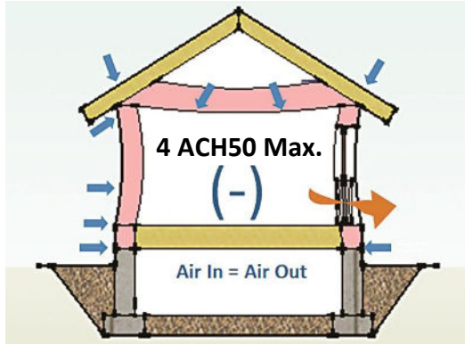
Depressurization Blower Door Test
